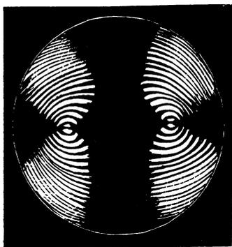
Рис. 69. Коноскопическая фигура двуосного кристалла (с малым углом оптических осей) в разрезе, перпендикулярном к оптической оси. Плоскость оптических осей совпадает с направлением колебаний поляризатора
