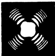
Рис. 92. Коноскопическая фигура одноосного вращающего кристалла
